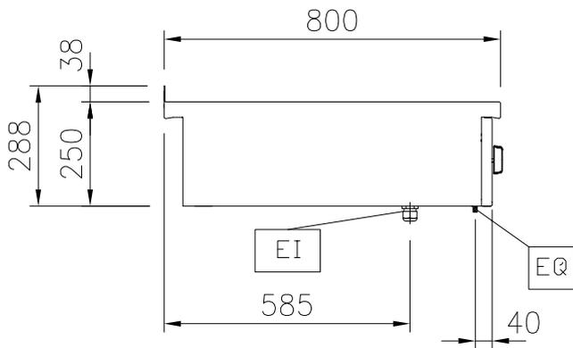
EI = Conexión eléctrica (energía)
